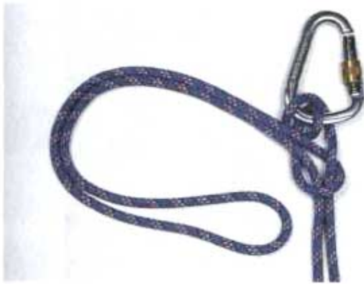
Фиксация итальянского выбленочного узла
